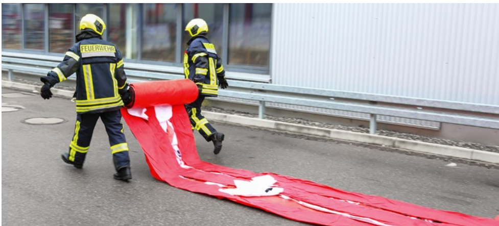
Die Sichtschutzwand ist zu zweit schnell ausgerollt und bereit, aufgeblasen zu werden.
