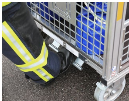
Neben einer Feststellbremse besitzt jede Lenkrolle Richtungsfeststeller, die ein Ausschwenken bei einem Richtungswechsel verhindern.
