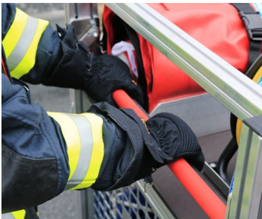
Totmannbremse: Beim Loslassen der roten Griffstange schließen die Trommelbremsen der Bockrollen.
